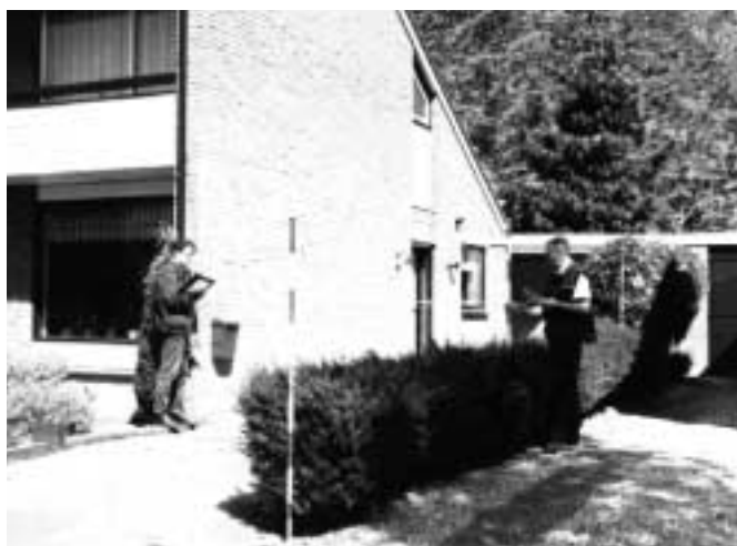
AFBEELDING 3: KADASTRALE LANDMETERS VERZAMELEN ATTRIBUTEN BIJ DE TOPOLOGISCHE GESTRUCTUREERDE GRENS, NADAT AANWIJS VAN BETROKKEN PARTIJEN ACHTER DE RUG IS (FOTO KADASTER).
